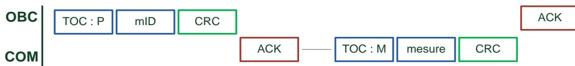
FIGURE 30 - DONNÉES ÉMISES ET RECUE LORS DE L'ACQUISITION D'UNE MESURE DE LA COM
