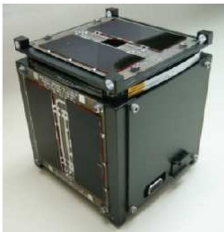
Figura 2: Il primo CubeSat costruito al California Polytechnic
