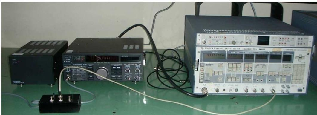
Figura 3.2 Foto delle misure sul Kenwood: alimentatore, Kenwood, scatola delle misure, SMFP2
