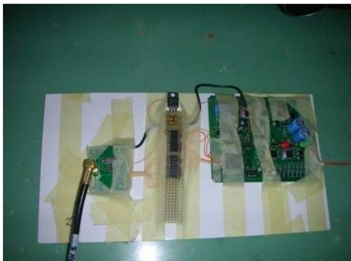
Figura 3.8 Scheda con il CC1100 il TTL e il microprocessore.
