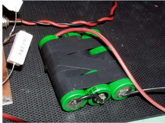
Figura 3.8: *Celle al litio utilizzate per la realizzazione sperimentale.*
