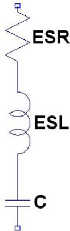
Figura 3.39: Circuito equivalente per i condensatori
