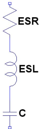
**Figura 3.4**      **Circuito equivalente del condensatore**
