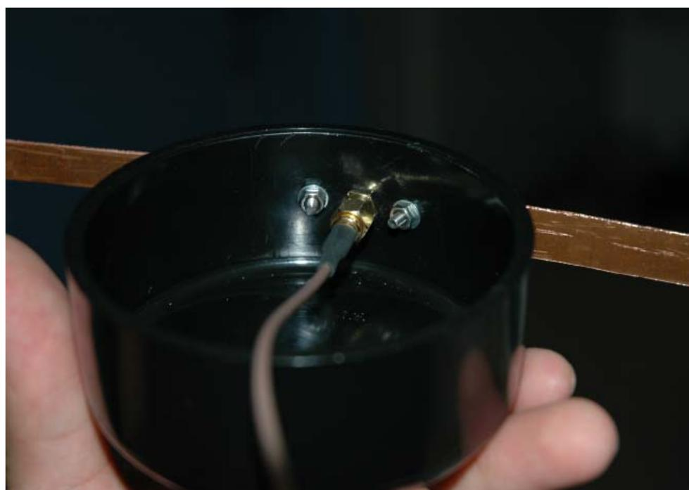
**Fig VII-3. Particolare sul fissaggio dell'antenna a dipolo**
