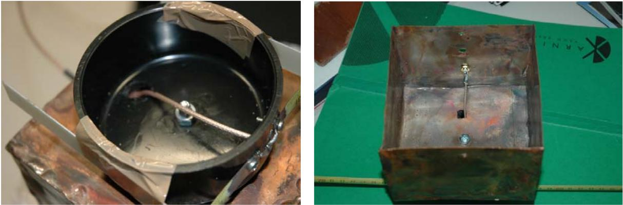
Fig VII-17. La realizzazione del “Balun”
