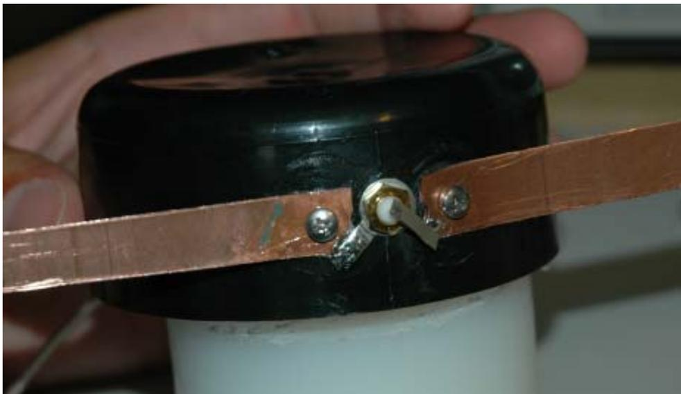
**Fig VII-4. Particolare sull'alimentazione dell'antenna a dipolo**
