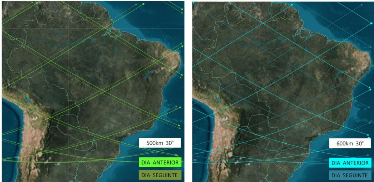
**Figura 24.** Comparação entre as repassadas para altitudes de 500 km e 600 km
